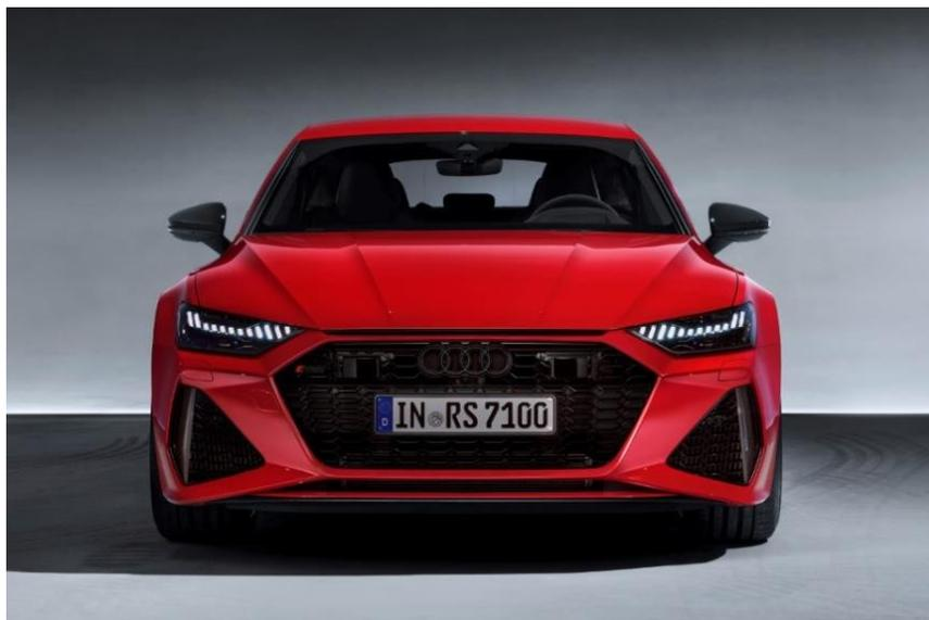
La luz láser Audi, reconocible por el marcador azul en el reflector, duplica el alcance de las luces largas. En cada faro, un pequeño módulo láser genera un cono de luz que actúa como un foco que se extiende varios cientos de metros. El haz láser tiene una longitud de onda de 450 nanómetros. Un convertidor de fósforo lo transforma en una luz suave apta para su uso en
