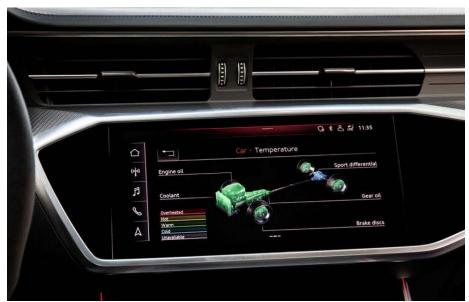
La pantalla superior de 25,6 cm (10,1 pulgadas) se utiliza para controlar el sistema de infotainment. El conductor puede utilizar el RS monitor para consultar un resumen de las temperaturas de los componentes del sistema de propulsión, las fuerzas g máximas e información sobre la presión y la temperatura de los neumáticos. La pantalla inferior de la
