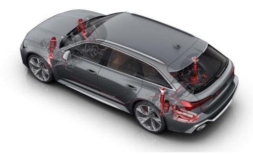
Cuando el vehículo toma una curva se genera un flujo de aceite entre los amortiguadores diagonalmente opuestos a través de la válvula central, creando así una fuerza de amortiguación adicional. Las características de la amortiguación se modifican de tal manera que los movimientos de balanceo y cabeceo se eliminan casi por completo. Como resultado, este sistema garantiza que el Avant de altas prestaciones sea especialmente preciso al trazar curvas.
