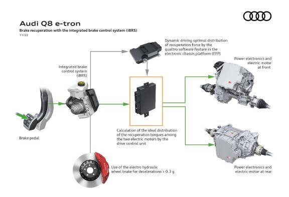
Para evitar la aparición de óxido en los discos de acero del sistema de frenos, una función de autolimpieza opta por utilizar los frenos de fricción en determinados intervalos aunque la recuperación sea posible, manteniendo el sistema en condiciones ideales de funcionamiento.
