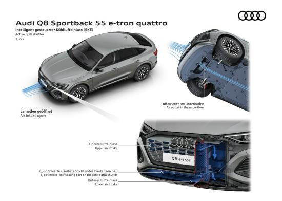
La toma de aire de refrigeración también se abre cuando el sistema de frenos hidráulicos está sometido a grandes cargas, abriendo dos conductos que dirigen el flujo a los pasos de rueda delanteros. El Q8 e-tron es el primer modelo de Audi que utiliza un sistema de autosellado de nuevo desarrollo, que aprovecha todo el potencial de esta tecnología de control del aire con un
