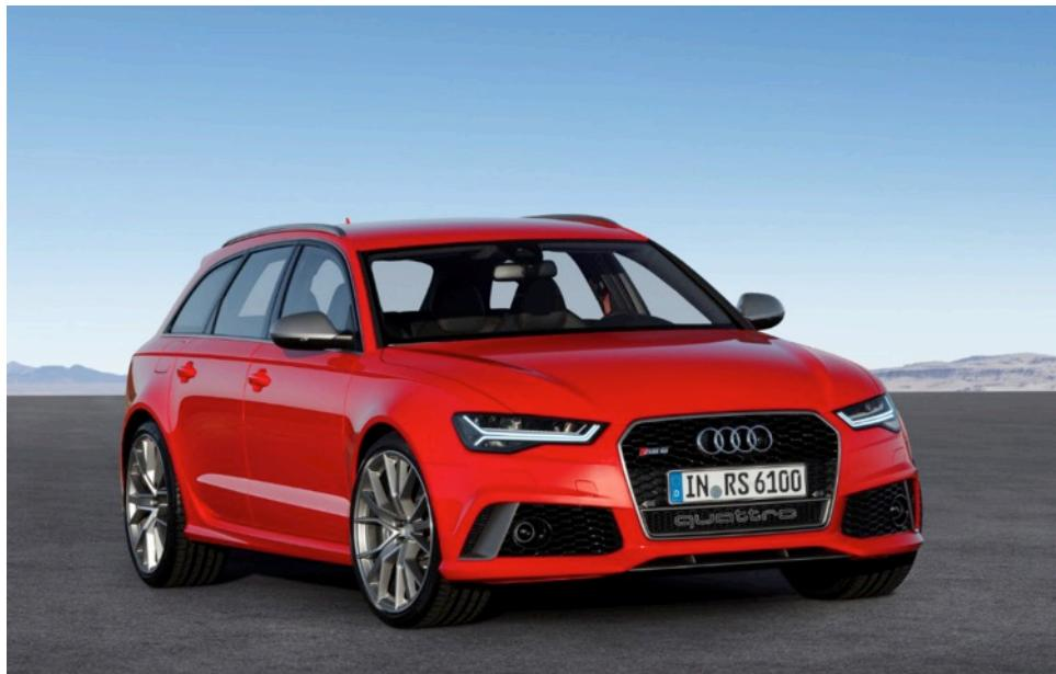
Con 4 litros de cilindrada, su motor V8 biturbo rendía 412 kW (560 CV). Con bajas cargas sobre el acelerador, el sistema cylinder on demand (COD) desactivaba temporalmente cuatro cilindros, contribuyendo en gran medida a mejorar su eficiencia. La potencia se transmitía aquí mediante un cambio **tiptronic de ocho velocidades** de rápido accionamiento y una refinada **tracción quattro** cuyo diferencial central podía producir una mayor relación de bloqueo cuando era necesario.
