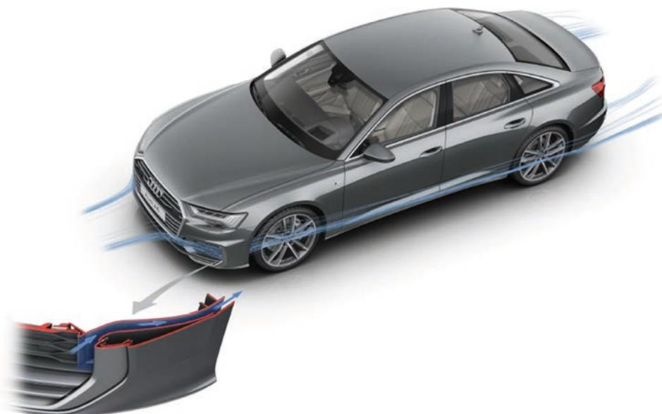
En los bajos del coche unos paneles cubren la zona del vano motor, las áreas laterales de la célula de pasajeros, la zona trasera, el depósito de combustible y el catalizador SCR. Pequeños spoilers y otros elementos aerodinámicos delante de las ruedas anteriores se encargan de canalizar el aire.
