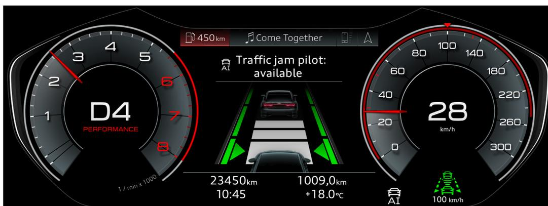
Si se cumplen estas condiciones, una señal luminosa indicará al conductor que el sistema está disponible: en primer lugar, el botón Audi AI en la consola del túnel central se iluminará con
